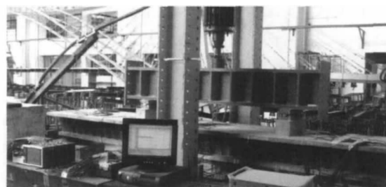
图4 疲劳试验加载装置
