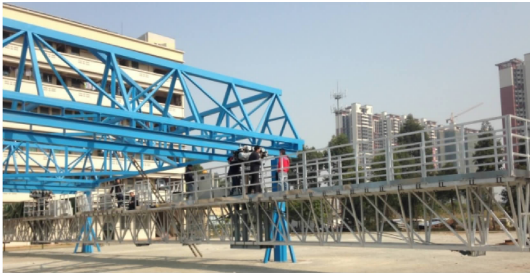
图 12 梁外检修车走行试验
