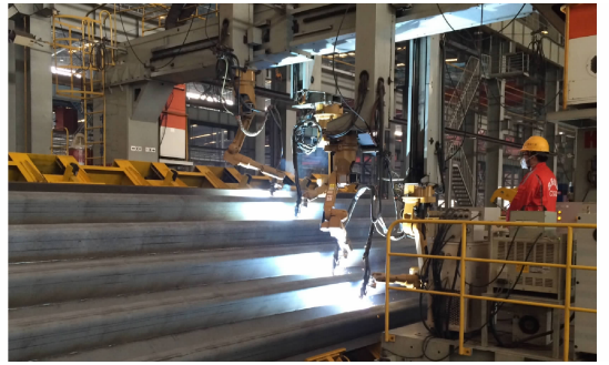
图7 U肋机器人自动焊接系统
