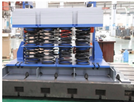
图 6 钢箱梁调谐质量阻尼器
